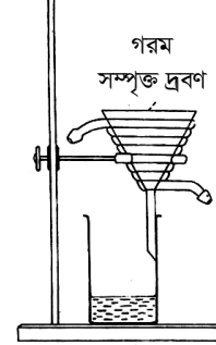
চিত্র-৪.১ (গ) : হট ওয়াটার ফানেলের সাহায্যে পরিস্রাবণ
