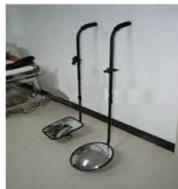
চিত্র : ৯.৩৫ গাড়ীর তলা নিরীক্ষণ দর্পণ
